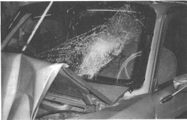
Bild 104: Crash-Test entsprechend FMVSS 212 mit eingeklebtem Windschutzscheibenrahmen aus PUR-Integralschaum mit nicht angeschnallten Dummies.
