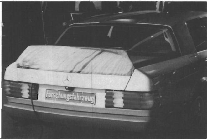
Bild 26: Kunststoffheckscheibe des Daimler Benz Forschungs-Pkw "Auto 2000".
