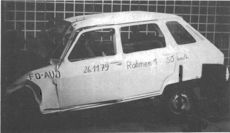
Bild 103: Vorversuch mit geklebter VSG-Scheibe auf Vorsatzrahmen und PUR-Integralschaumstoffstreifen.
