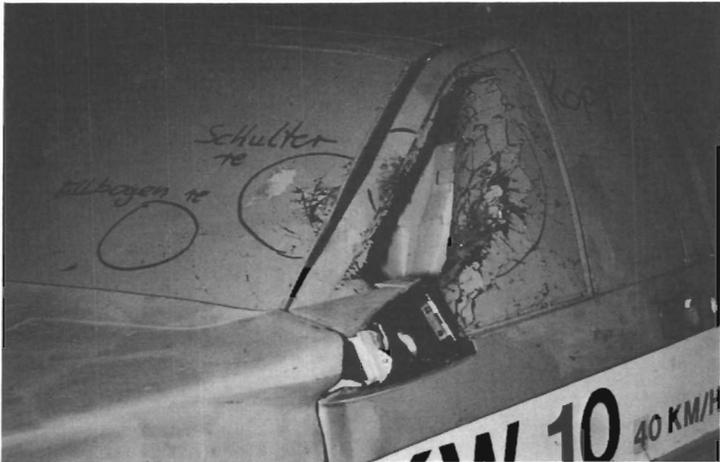
Bild 101: A-Pfosten nach Kopfaufprall eines Radfahrers.
