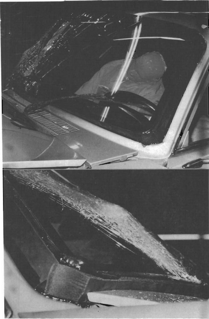
Bild 105: Scheibenrahmenpolster nach Versuch mit 50 km/h
