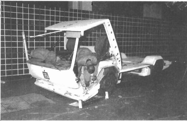
Bild 57: Kunststoff-Lkw nach Crash-Test an der TU Berlin.
