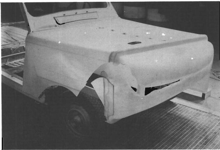
Bild 123: Deformationselement aus tiefgezogener PVC-Schale am Versuchsfahrzeug nach Barrierenaufprall mit 6 km/h.
