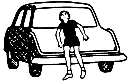
Phase 2: Der Stoßfänger prallt zuerst gegen die Beine des Fußgängers. Ein Sensor löst die Schutzeinrichtung aus.
