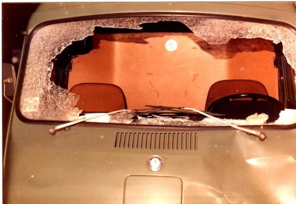
ESG : nach dem Bruch viele freistehende Kanten der im Rahmen verbliebenen Glasreste.
