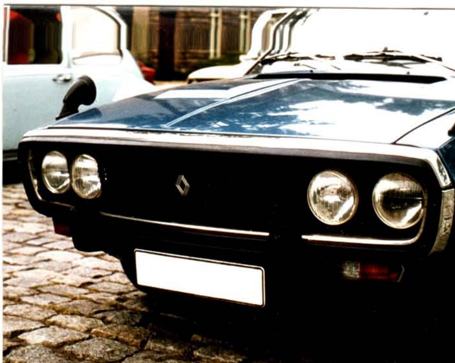
Gepolsterte Haubenkante durch um den Kühlergrill herumgelegte Gummileiste
