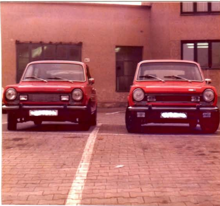
oben: im Kühlergrill eingelassene Zusatz- fernscheinwerfer
