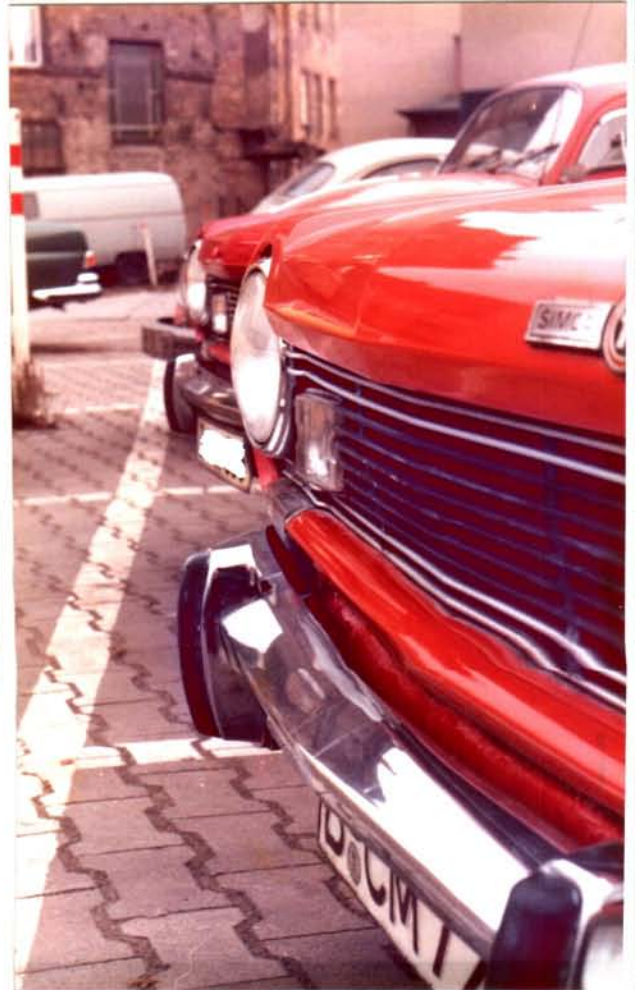
oben: im Kühlergrill eingelassene Zusatz- fernscheinwerfer
