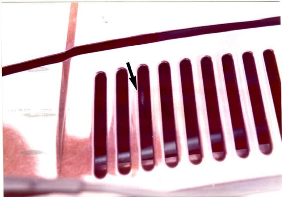
besser: versenkte Düsen spritzen durch die Belüftungsschlitze in der Motorhaube
