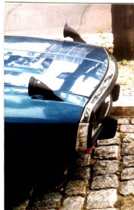
Gepolsterte Haubenkante durch um den Kühlergrill herumgelegte Gummileiste
