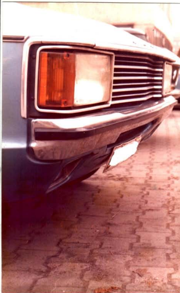
unten: in die Frontschürze versenkte Nebelscheinwerfer
