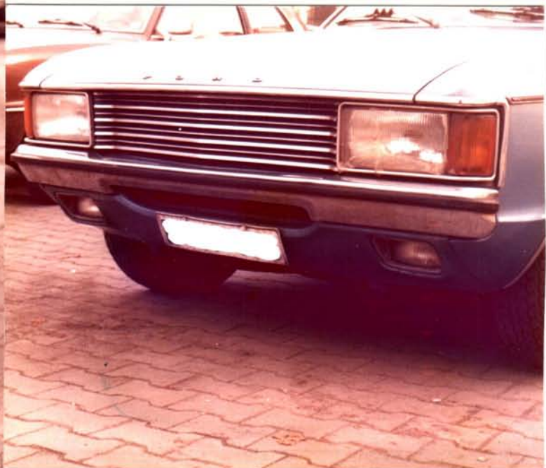
unten: in die Frontschürze versenkte Nebelscheinwerfer
